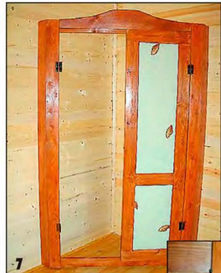
Приступаем к окончательной сборке шкафа. Для навешивания дверок мы выбрали декоративные бронзовые петли.
