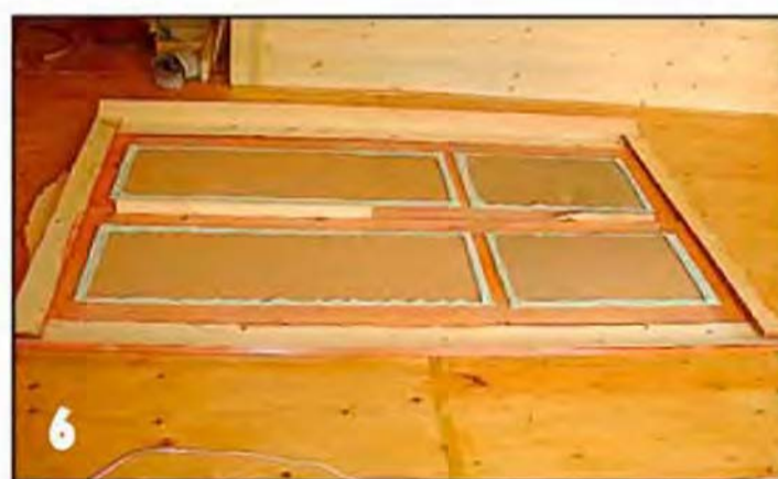
Уложив лицевой стороной к полу собранный с рамами дверных полотен каркас, вставляем на место обтянутые льняной тканью филёнки.
